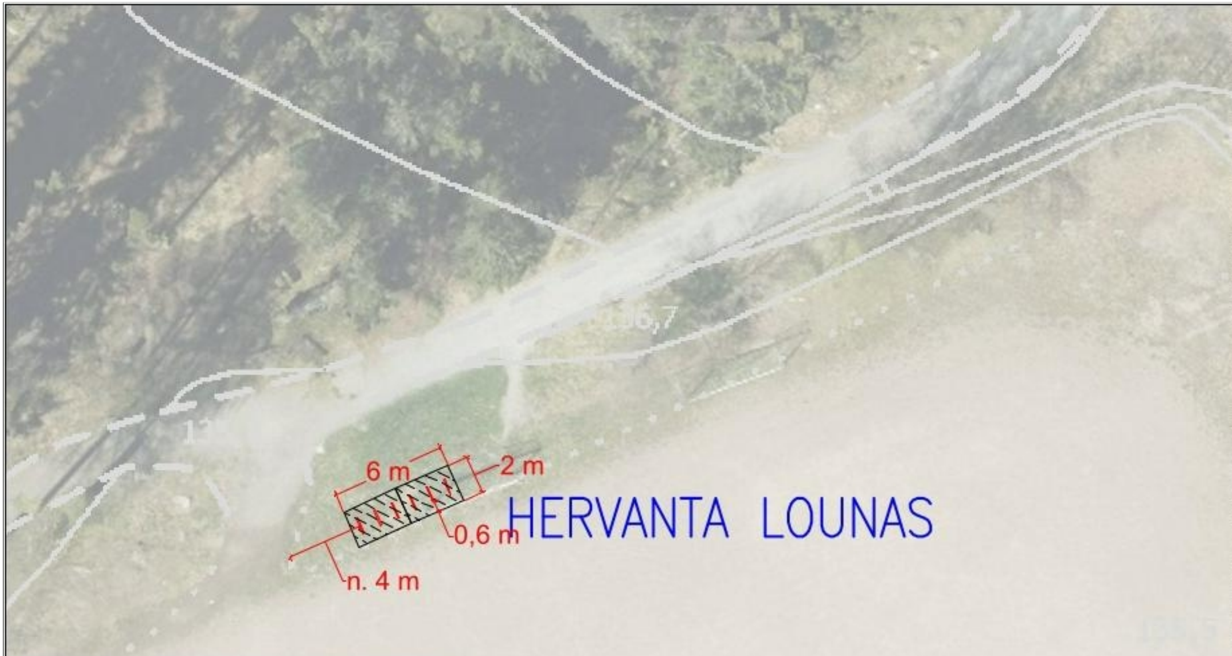
PERIAATEKUVA UPPOASENNUKSESTA (MITAT RIIPPUU VALMISTAJASTA)
